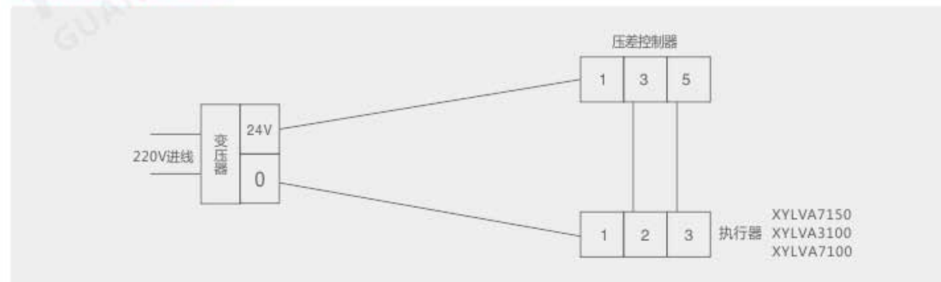
电动压差旁通阀连线图
